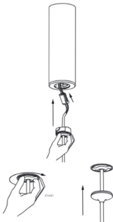
DE Über einen spürbaren Widerstand drehen. Beim Einsetzen der Leuchte nicht drücken. Nicht in die falsche Richtung drehen.
